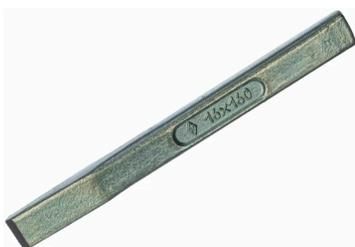
Зубило предназначено для рубки незакаленных металлов, демонтажа кирпичных и бетонных сооружений, а также для накернивания металла в резьбовых соединениях при его залипании.
